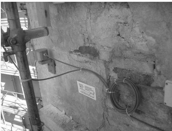
Foto 3. Clinometro nella parte alta della vecchia muratura da conservare lato rio de la Fenice
